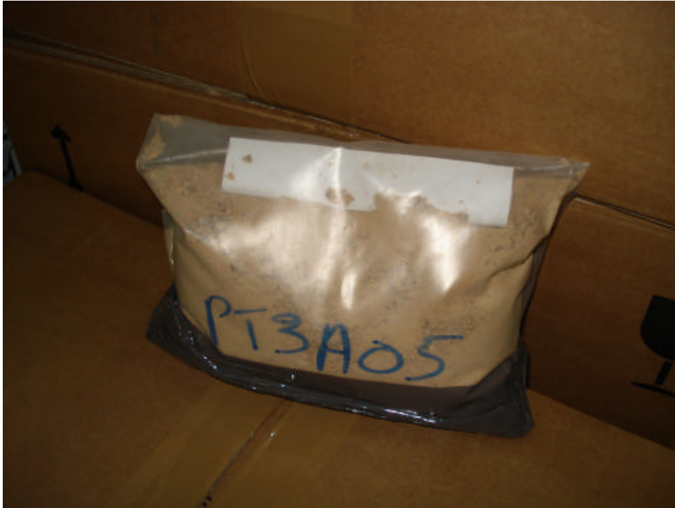
Photo n° 17 : Echantillons sol mis en conditionnement. Il a été préalablement préparé par étape successif à l'aide d'un échantillonneur à couloirs.
